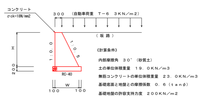
境界位置に施工 5号坂路擁壁 S=1:50 (全面勾配 直タイプ) H ≤ 1.60m
